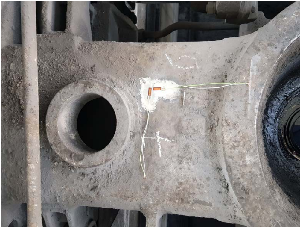
Рис. 6 – Приклад встановлення розетки тензорезисторів на рамі візка в зоні модернізованого технологічного отвору та кронштейну підвісу редуктора
