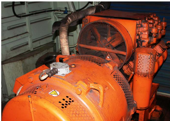
Рис. 5 – Мотор-компресор ПК-5,25А електровозу ДЕ1 [9]
