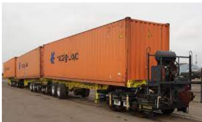
Рис. 12 – Формування поїзда із платформ RAILRUNNER
