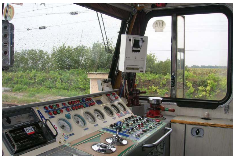
Рис. 6 – Пульти управління електровозом ДЕ1 з його системою діагностування та швидкостеміром "ВЕКТОР" [12]
